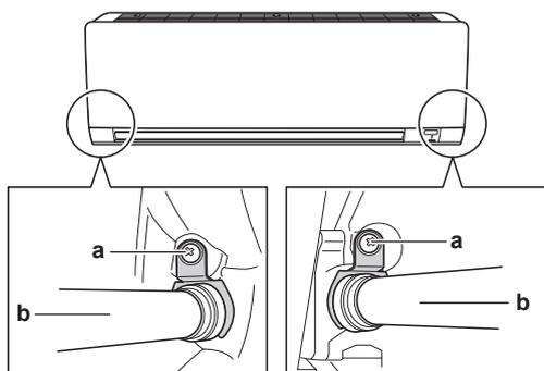
a Крепежный винт для изоляции
